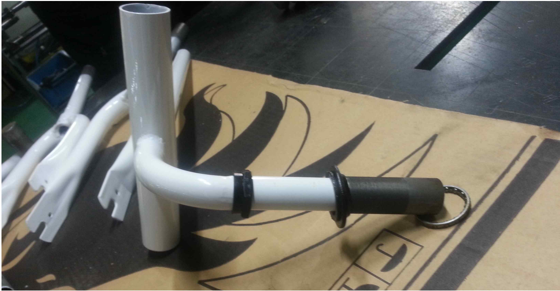
Fig 3.4. 유모차지지 부 회전축 베어링 삽입 사진
