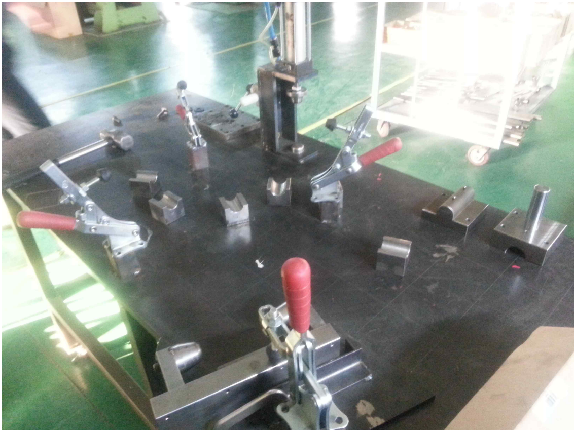
Fig 3.2. Main Frame 제작에 사용한 지그의 전체적인 완성도
